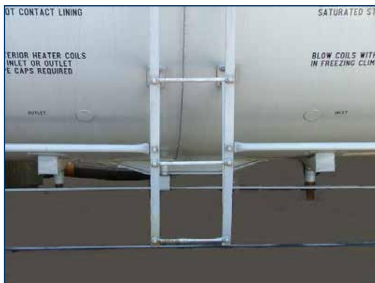
Cette photo illustre l'entrée et la sortie du circuit de chauffage sous un wagon-citerne.
