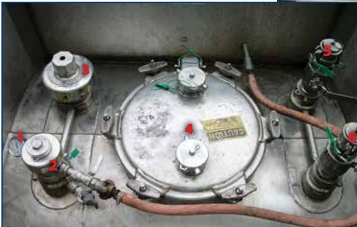
La photo ci-contre à gauche indique les raccords sur le dessus d'une remorque citerne : 1 ) manomètre ; 2 ) reniflard ; 3 ) soupape de pression ; 4 ) trappe d'accès ; 5 ) vannes et raccords d'échange de vapeur ; 6 ) arrivée d'air du dessiccateur.
